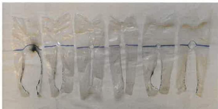
Vzorky po zkoušce – expozice hrany
